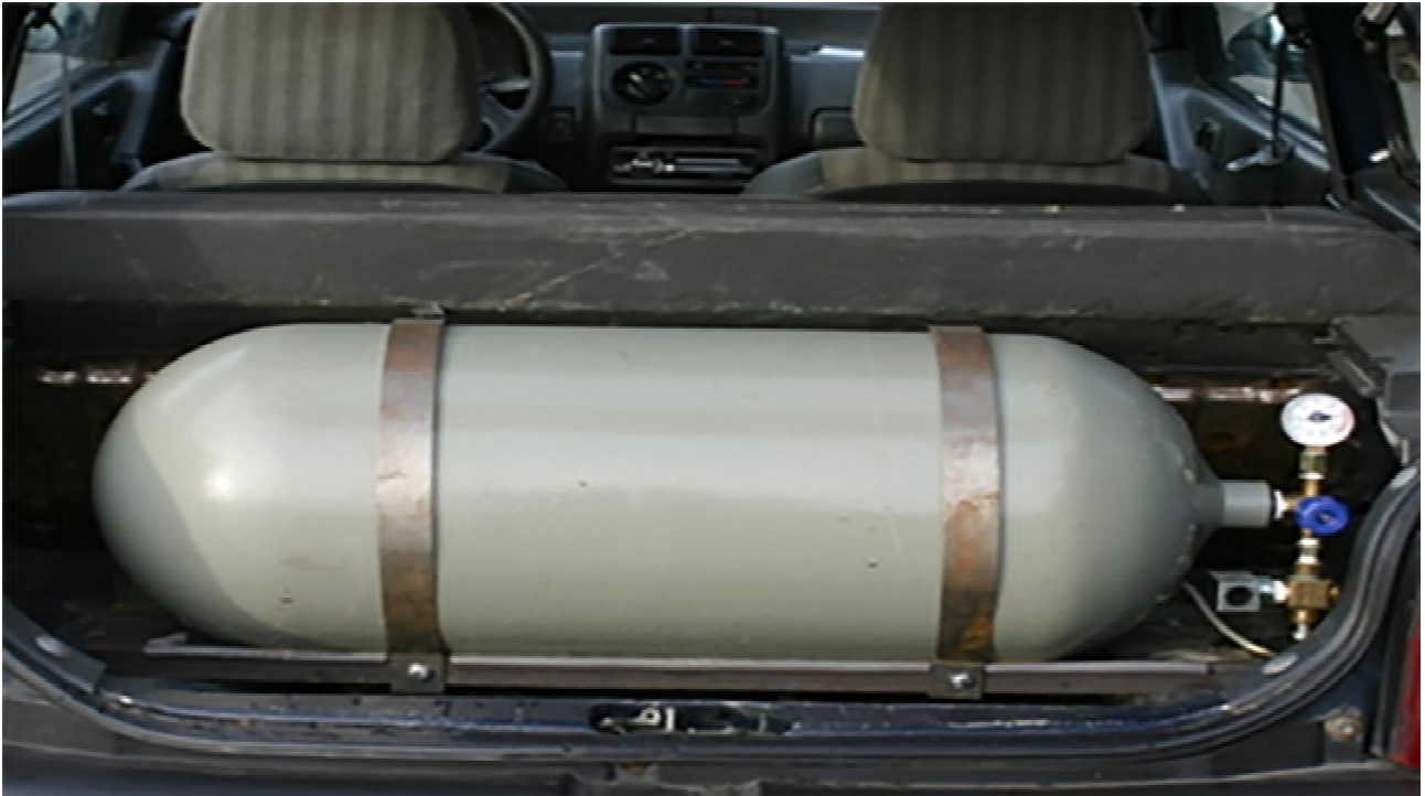
სურათი 1. აირბალონზე ონკანის დამაგრების ფორმა
