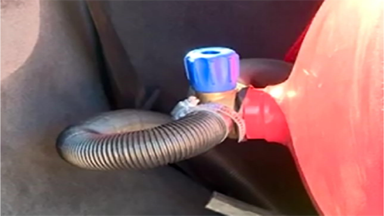
სურათი 2. აირბალონიდან გაზის გაჟონვის შემთხვევაში ავტომობილის სალონის დამცავი გოფრირებული მილი
